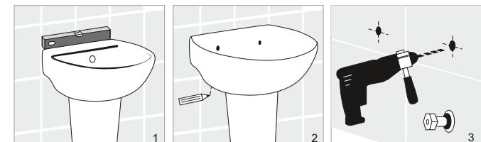
1. К приготовленной для монтажа на стене приложите умывальник, установив его на пьедестал и выровняв его по горизонтали, используя уровень (рис 1).
