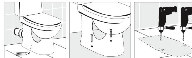
3. Просверлите и установите дюбели. Прикрутите постамент унитаза к полу, используя входящие в комплект болты. Во избежание скопления влаги под унитазом после мытья полов и повышения устойчивости, рекомендуем заделать соединение постамента унитаза с полом плиточным клеем или герметиком.
